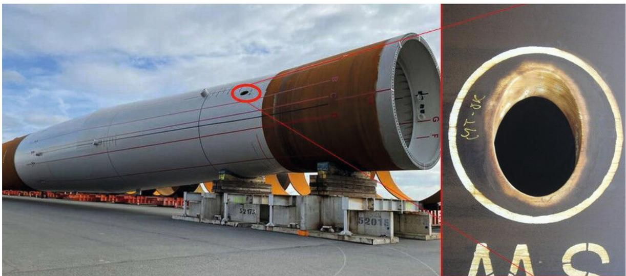
Stahlbautypisches Konstruktionsdetail mit charakteristischem Ermüdungsversagen infolge von Spannungsüberhöhung durch Kerbwirkung. Quellen: (links) [www.industr.com/de/erste-xxl-monopiles-stechen-in-see-2645672](http://www.industr.com/de/erste-xxl-monopiles-stechen-in-see-2645672), (rechts) [www.subenesol.co.uk/Products/SUB-BUNG-OWF-S-Subsea-Diver-Installed-Bungs](http://www.subenesol.co.uk/Products/SUB-BUNG-OWF-S-Subsea-Diver-Installed-Bungs)
