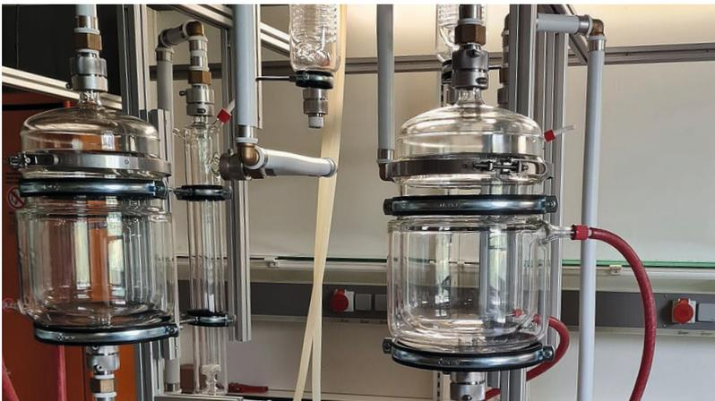
*Pilotanlage zur separierenden Trägerdampfdestillation.
