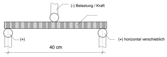
Mit einer Prüfmaschine wird über den Stempel (-) die Kraft (Belastung) auf die Brücke übertragen. Die Brücke ist auf beiden Seiten ebenfalls auf Stempeln (+) aufgelagert. Zwischen den Auflagerstempeln ist Luft. Die Brücke muss so gebaut werden, dass sie möglichst viel Belastung tragen kann.
