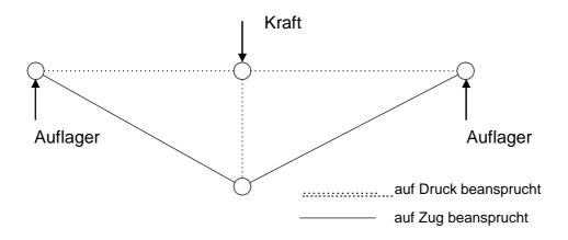
Die Stäbe müssen entsprechend ihrer Beanspruchung ausgebildet werden. Die Mittelstütze z. B. erhält in der im oberen Bild dargestellten Konstruktion immer die gesamte Kraft als Druckkraft. Die Tragfähigkeit der o. g. Konstruktion hängt entscheidend vom Querschnitt der Mittelstütze ab.
