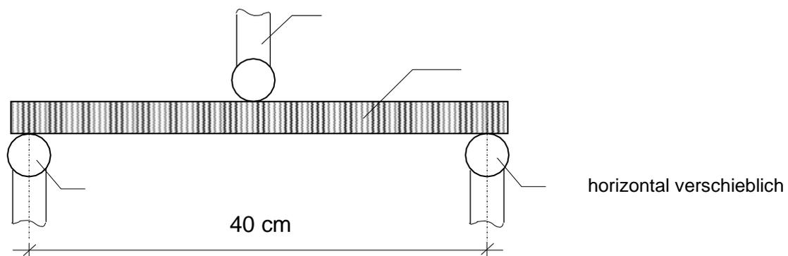
Mit einer Prüfmaschine wird über den Stempel ( ) die Kraft (Belastung) auf die Brücke übertragen. Die Brücke ist auf beiden Seiten ebenfalls auf Stempeln ( + ) aufgelagert. Zwischen den Auflagerstempeln ist Luft. Die Brücke muss so gebaut werden, dass sie möglichst viel Belastung tragen kann.
