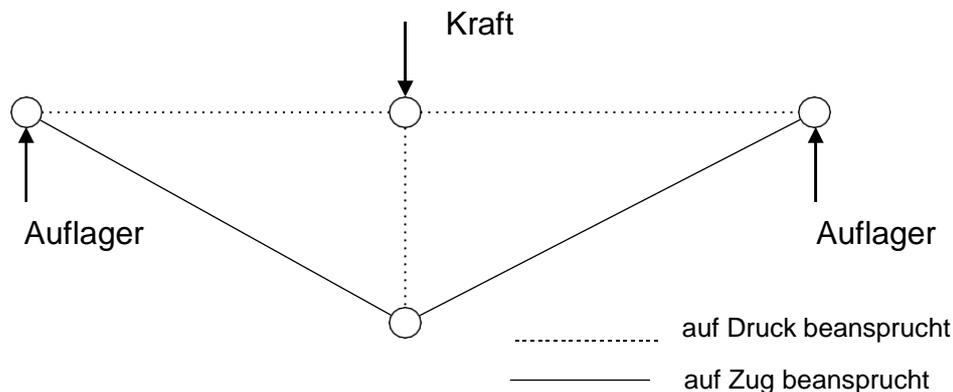
Die Stäbe müssen entsprechend ihrer Beanspruchung ausgebildet werden. Die Mittelstütze z. B. erhält in der im oberen Bild dargestellten Konstruktion immer die gesamte Kraft als Druckkraft. Die Tragfähigkeit der o. g. Konstruktion hängt entscheidend vom Querschnitt der Mittelstütze ab.
