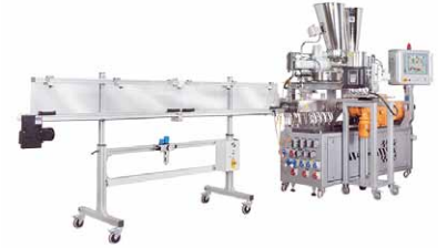
Gesamtansicht: im Rahmen des Projektes zur Rezepturentwicklung eingesetzter Doppelschneckenextruder ZSE 27 MAXX / Overall view: Twin-screw extruder ZSE 27 MAXX used in the formulation development project
