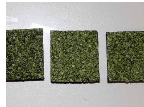
Dach-Bahn-Muster nach der Algen-Beimpfung im Labor / Roof bitumen pieces after algae inoculation in the lab
