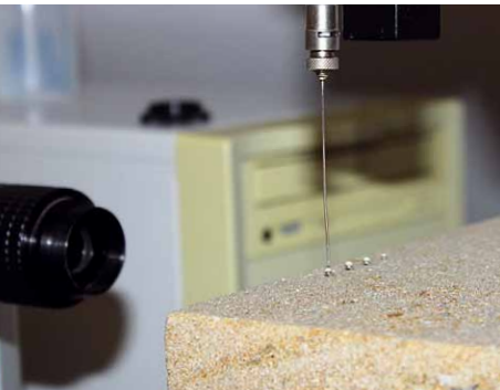
Moment-Aufnahme der Baustoffoberfläche für die Bestimmung des Hydrophobierungsstatus über die Benetzungswinkelmessungen/ Single photo of material surface for estimating the hydrophobic status using moisture angle measurements
