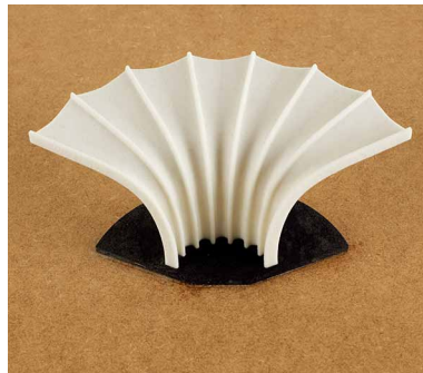
Modell einer Betonschale (Musikpavillon „Kurmuschel“ in Sassnitz) im 3D-Druckverfah- ren hergestellt / Model of a concrete shell ("Kurmuschel" music pavilion in Sassnitz), produced using 3D printing
