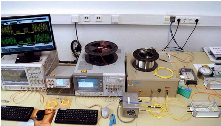
Bild 2: Testbed zur Untersuchung der optischen MIMO-Übertragung/ Fig. 2: Testbed for examination of optical MIMO transmission
