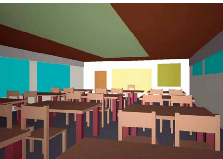
Klassenraum mit raumakustischen Maßnahmen, Senkung der Nachhallzeiten mit Gewinn für die Nutzungsqualität hinsichtlich Sprachverständlichkeit und Lärmschutz / Classroom with room-acoustic measures, reduction of reverberation time that leads to improved user quality related to speech intelligibility and noise protection.
