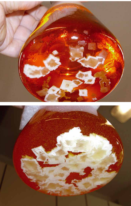
Darstellung des Wachstums der Thymol- kristalle über einen längeren Zeitraum / Image of thymol crystal growth over a longer period of time
