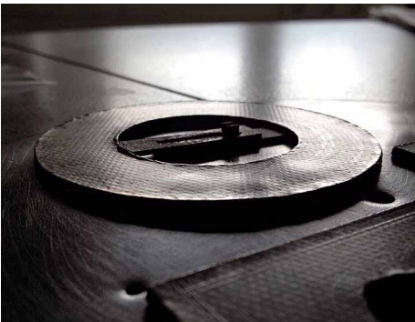
Graphitdichtungsprobe vor der Beschichtung in der PECVD-Anlage / Graphite seal sample before coating in PECVD plant (Quelle/Source: Master-Thesis M. Dobbertin 2014)
