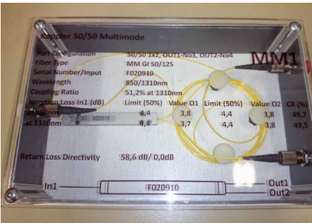
Optimierter Schmelzkoppler zum Einsatz in der optischen MIMO-Übertragung / Optimized fusion-coupler for using within an optical MIMO transmission
