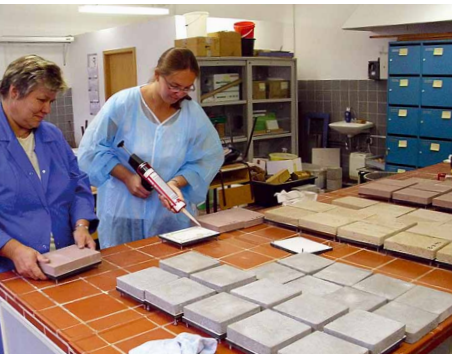
Vorbereitung von Prüfkörpern im Labor/ Preparing reference blocks in the lab
