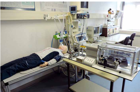
Patienten-Dummy und entwickelter Lungensimulator im AUTOMED-Lab / Patient-dummy with lung-simulator in the AUTOMED-Lab
