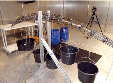
Versuchsaufbau zur Prüfung des CFK-Bogens unter statischer Last / Experimental set-up for testing the FRP-arch under static load
