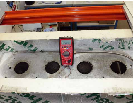
Ansicht des Demonstrationsmodells von oben mit integrierten Behältern für PCM-Materialien zur Erhöhung der Wärmekapazität (Phase-Change-Material) / View of the demonstration model from above with integrated containers for PCM materials for increasing heating capacity (phase change material)
