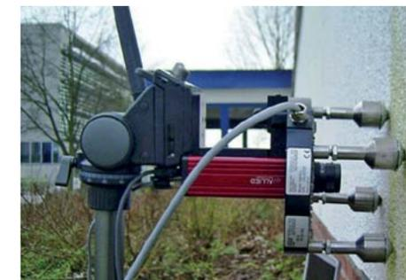
Untersuchung einer Testfläche mit dem Imaging PAM /
