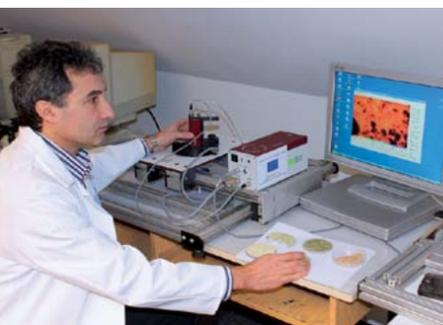
Bestimmung des Algen-Besiedlungsgrades an Baustoffprüfkörpern vom Bewitterungsstand der Hochschule Wismar mit Hilfe des IMAGING-PAM-Gerätes / Determining the degree of colonisation of algae specimens on buildings in relation to weathering at the University of Wismar using the IMAGING-PAM device.
