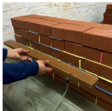
Bild 1: Untersuchtes Mauerwerk mit ideeller Mörtelschicht /
