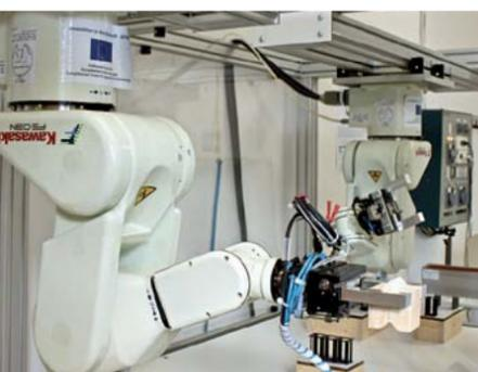
Einer der Roboter bei einer Sortieraufgabe im Einsatz mit der Projektsoftware / One of the robots in use in a sorting task using the project software
