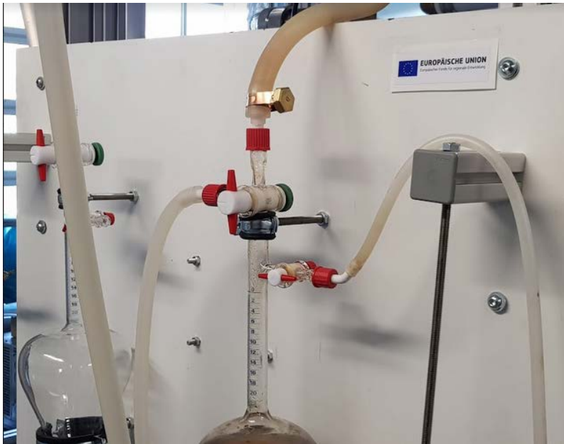
Abbildung 2: Probengewinnung der überdestillierten ätherischen Öle
