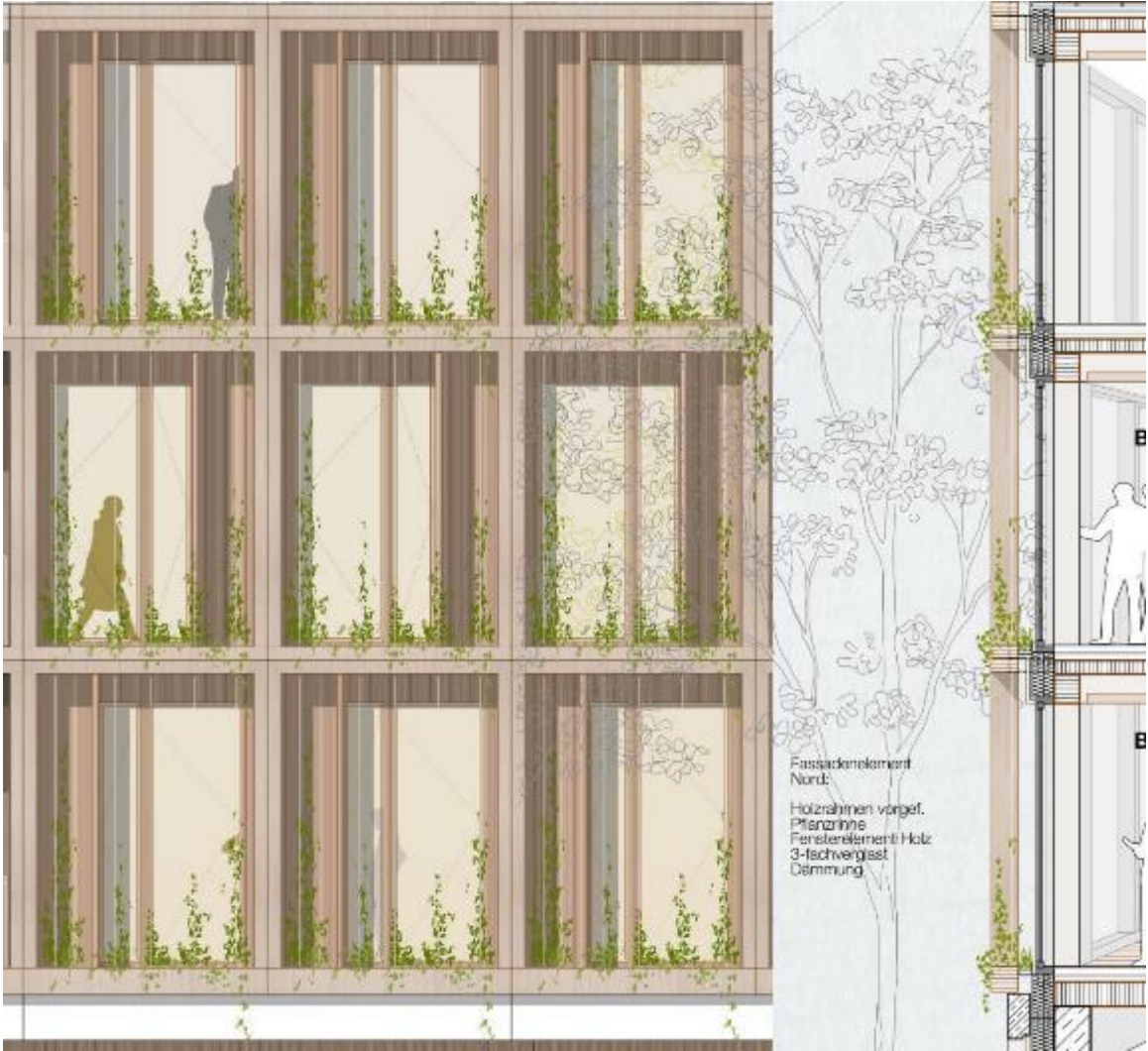
Straßenfassade - Begrünung und bodentiefe Fenster
