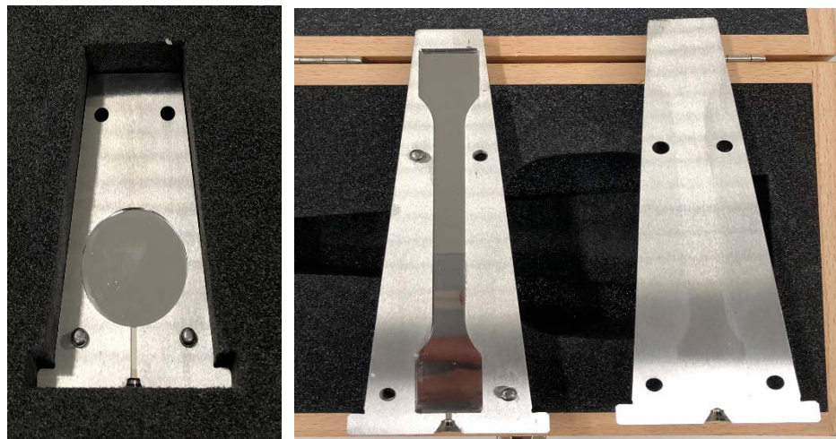
Werkzeuge für Mini-Spritzgießmaschine: links: Kreisscheibe; rechts: Vielzweckprüfkörper nach ISO 527 - 2 - 1A
